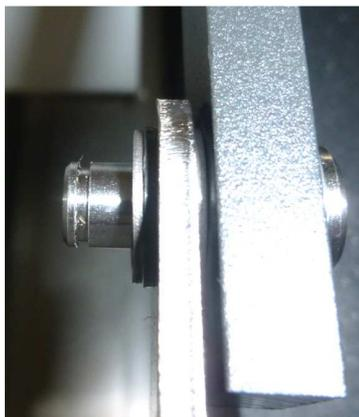
**ACHTUNG:** Beim Einsetzen des Splints besteht die Gefahr des Herausdrückens der kleinen Plastikhülsen. Zum Einsetzen der Sicherungsclips wird empfohlen ein entsprechend dafür geeignetes Werkzeug zu benutzen.
