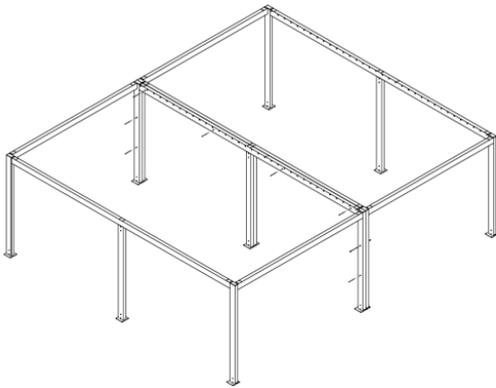
15. Die aufgestellten Module sind mit diesen mitgelieferten Schrauben und Gewindestangen, wie in Zeichn. 12 und 13 miteinander zu verschrauben.
