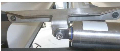
2. Setzen Sie in die Motorhalterung auf der Motorseite jeweils eine kleine Plastikhülse in beide Öffnungen (Zeichn. 25).
