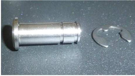
3. Zur Verbindung der Zugstange mit den Lamellenendkappen und der Motorhalterung verwenden Sie die Splinte und die kleinen Sicherungsclips. Der Splint hat 2 Rillen: Die äußere Rille ist nur bei der Motorhalterung zu verwenden. Die innere Rille ist bei der Montage aller anderen Lamellenendkappen an der Zugstange zu verwenden (ohne Motorhalterung) – Zeichn. 26.
