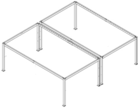
13. Stellen Sie ein neues Modul an das bereits verankerte Modul, gemäß ihrer planmäßigen Position. Vorm Verschrauben der Module miteinander ist zu prüfen, ob im neu aufgestellten Modul die Diagonalen übereinstimmen und alles im Lot und in Waage montiert ist. Falls notwendig, führen Sie Anpassungen durch (Zeichn. 10).
