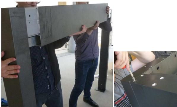
8. Setzen Sie die vordere und hintere Strebe auf den zuerst zusammengesetzten Konstruktionsteil in die Verbindungsstücke der Pfosten. Verschrauben Sie diese auf der Oberseite – wie in Zeichn. 5.
