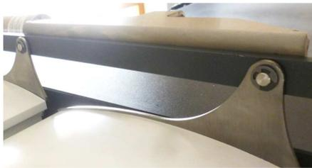
**ACHTUNG:** Der Motorkolben sollte vor der Montage komplett eingefahren sein (in dieser Pos. liefert ihn SELT aus). Beim Einsetzen des Splints besteht die Gefahr des Herausdrückens der kleinen Plastikhülsen. Zum Einsetzen der Sicherungsclips wird empfohlen ein entsprechend dafür geeignetes Werkzeug zu benutzen.
