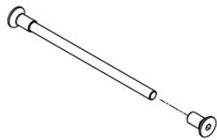
14. Für die Verbindung der Module SB400 sind die mitgelieferten Schrauben und Gewindestangen zu verwenden (Zeichn. 11). In den Streben und Pfosten sind dafür zueinander passende Löcher vorgebohrt.
