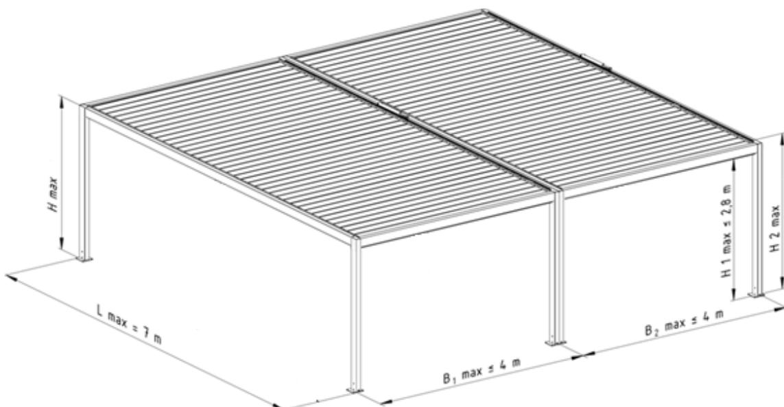
Zeichn. 2. Pergola SB 400 Modul - Abmessungen: **B** – Systembreite, **B 1 max** – max. Breite des Einzelnen Moduls, **L max** – max. Ausladung, **H max** – max. Konstruktionshöhe (3012 mm), **H 1 max** – Nischengröße, **H 2 max** – max. Befestigungshöhe des Motors zur Veränderung des Lamellenneigungswinkels (~3140 mm).
