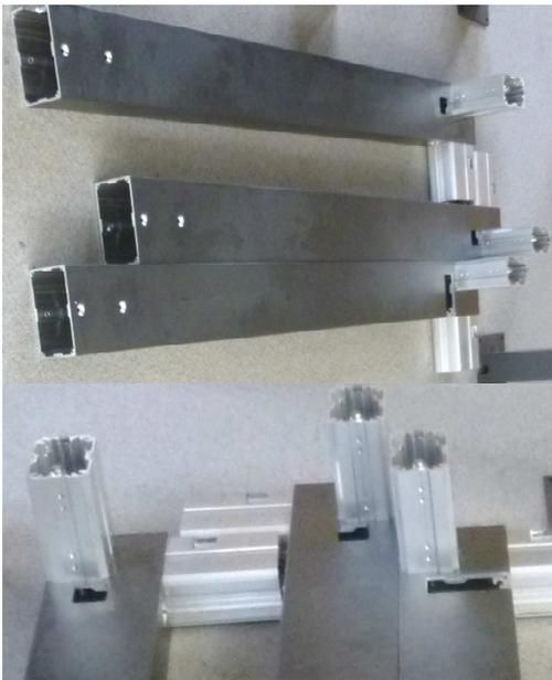
1. Legen Sie alle Profile an die entsprechende Position und alle Pfosten in die richtigen Ecken.
