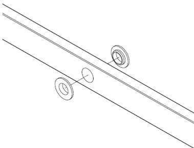
1. Stecken Sie die kleinen Plastikhülsen auf beiden Seiten der Zugstange in die Öffnungen (Zeichn. 24).
