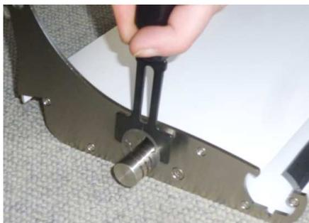
1. Stecken Sie den Sicherungsclip auf einer Seite in die mittlere Rille am Bolzen (in Zeichn. 21 – ist die Antriebsseite abgebildet). Wiederholen Sie dies für jede Lamelle **auf der gleichen Seite**.
