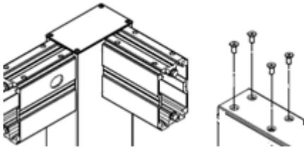
5. Setzen Sie eine seitliche Strebe (mit den Löchern für die Lamellen) mit den 2 richtigen Pfosten zusammen, indem Sie die Pfostenverbindungsstücke in die Streben-Enden stecken (große Kammeröffnung). Verschrauben Sie beides mit den Inbusschrauben M8x20 auf der Profilerseite (Zeichn. 5).
