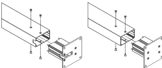
4. Bringen Sie alle FüÙe in den entsprechenden Pfosten an. Verschrauben Sie diese beidseitig mit den Inbusschrauben M8x20. Bei den FüÙen G, H, I achten Sie darauf, dass die Ausschnitte für den Wasserablauf mit denen in den Pfosten übereinstimmen.
