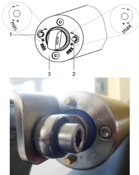
7. Schließen Sie den Motor an. Öffnen und Schließen Sie die Lamellen mit Hilfe des Montagekabels 2 Mal.
