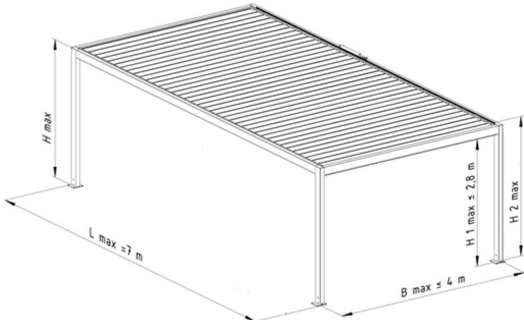
Zeichn. 1. Pergola SB 400 freistehend - Abmessungen: **B max** – max. Breite, **L max** – max. Ausladung, **H max** – max. Konstruktionshöhe (3012 mm), **H 1 max** – max. Nischengröße, **H 2 max** – max. Befestigungshöhe des Motors zur Veränderung des Lamellenneigungswinkels (~3140 mm).
